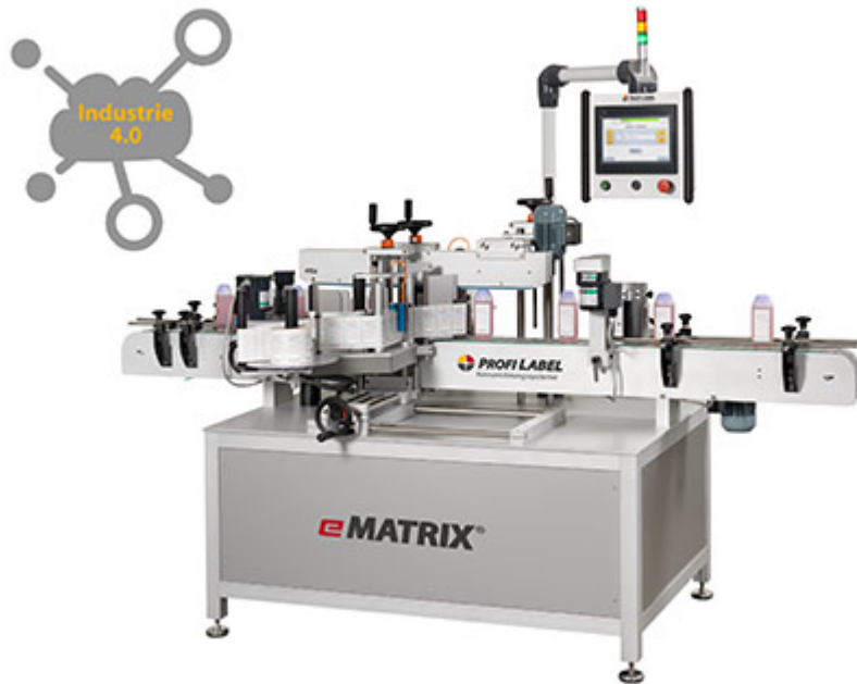
Abb. 3: Der neue Industrie 4.0-fähige Seiten- und Rundumetikettierer eMATRIX® X4225 von Profi Label kennzeichnet hochflexibel flache, ovale, viereckige sowie runde Gebinde. Das Umrüsten dieser multifunktionalen Maschine für den Produktwechsel erfolgt werkzeuglos in wenigen Handgriffen.
