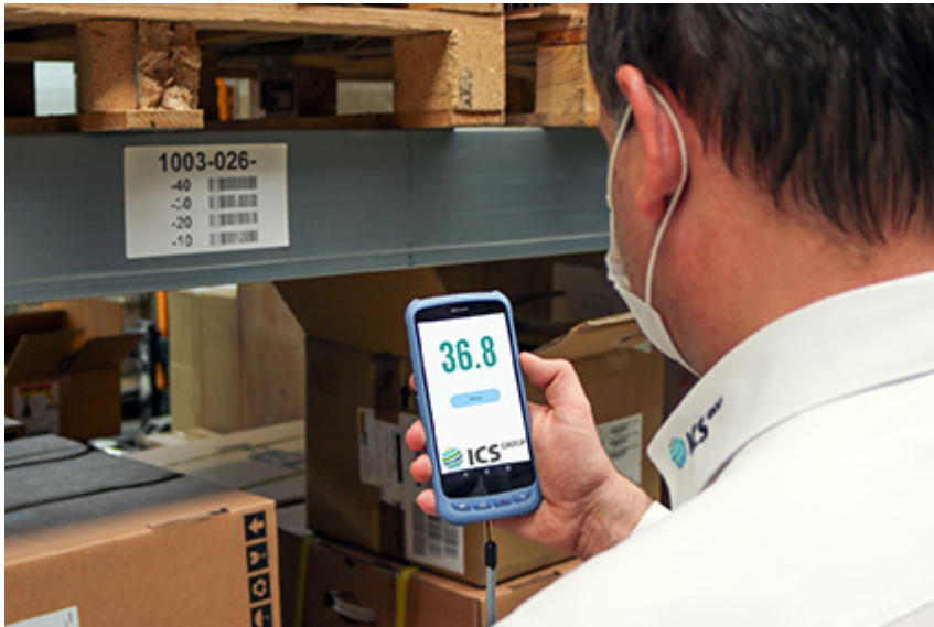
Abb. 3: Die mobile Anwendung des ICS Körpertemperatur-Screeningsystems kann jederzeit an jedem Ort mit WLAN- oder WAN-Verbindung stattfinden. Sie dient zur standpunktunabhängigen Temperaturmessung von Personen (Einsatz zum Beispiel durch Security-Personal) oder auch zur Selbstkontrolle von Fahrern und Dienstleistern mit Vor-Ort-Einsätzen.
